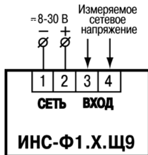
Рисунок Б.2 – Схема подключения прибора ИНС-Ф1.х.Щ9
