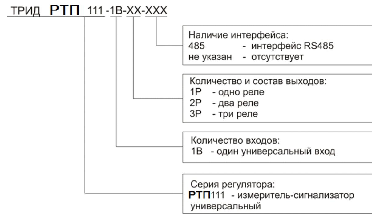
Рисунок 1.1 – Схема кода заказа для серии приборов ТРИД РТП 111
