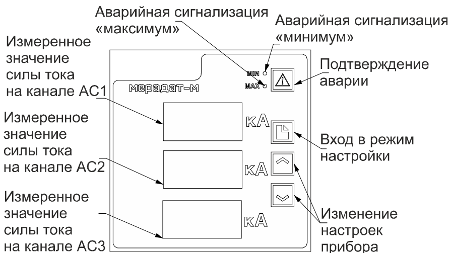
Рисунок 3 - Вид передней панели прибора, модель Мерадат-М3А
