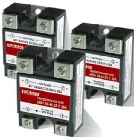
Твердотельные реле (ТТР) KIPPRIBOR серии HDH предназначены для управления однофазной электрической нагрузкой от 60 до 120 А. Реле серии HDH изготавливаются с двойным SCR-выходом (два тиристора, наращенных непосредственно на охлаждающей подложке, и разнесенных друг от друга), что позволяет достичь более качественного рассеивания тепла по сравнению с другими типами твердотельных реле, а так же выдерживать номинальные токи на резистивной нагрузке длительный период времени.
