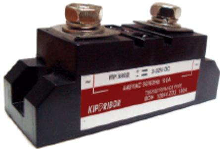
Промышленные твердотельные реле KIPPRIBOR серии BDH предназначены для управления мощной однофазной электрической нагрузкой от 100 до 250 А. Реле серии BDH изготавливаются с двойным SCR-выходом (два тиристора, наращенных непосредственно на охлаждающей подложке, и разнесенных друг от друга), что позволяет достичь более качественного рассеивания тепла по сравнению с другими типами твердотельных реле., а так же выдерживать номинальные токи на резистивной нагрузке длительный период времени.
