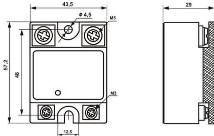
Габаритные размеры твердотельного реле KIPPRIBOR указаны в мм.
