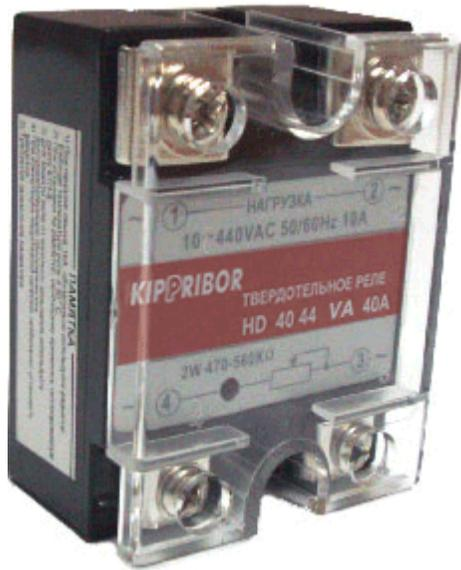
Твердотельные реле KIPPRIBOR серии HD предназначены для управления однофазной электрической нагрузкой от 10 до 80 А. Реле серии HD изготавливаются в нескольких модификациях и отличаются типом управляющего сигнала и родом тока коммутируемой цепи. Твердотельные реле с управлением переменным резистором позволяет вручную регулировать напряжение нагрузки.
