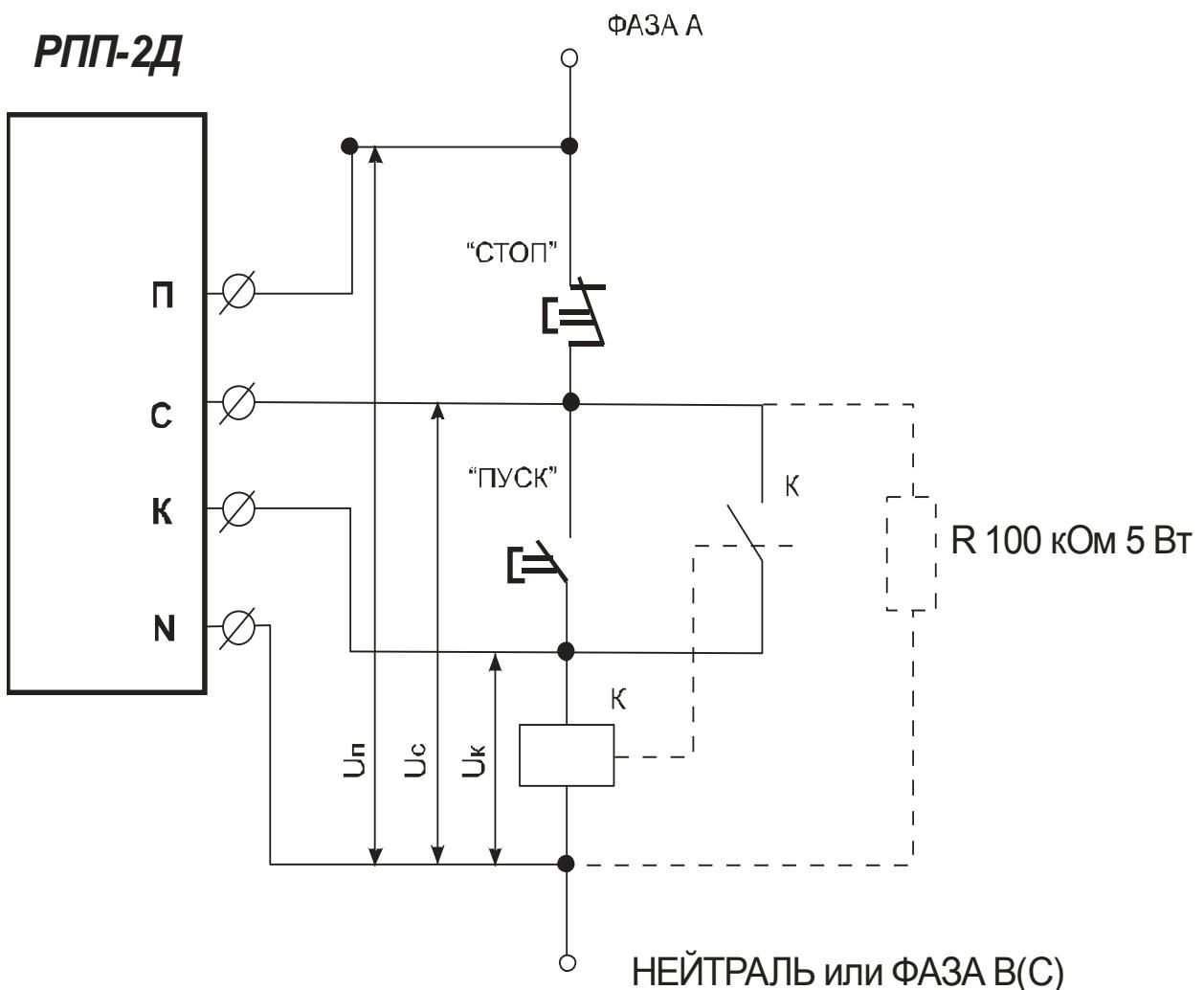
Рисунок 3 – схема подключения дополнительного резистора для подавления наведенной ЭДС. Наличие наведенной ЭДС в цепи «С» при большой длине соединительных проводов приводит к ложному срабатыванию реле при нажатии кнопки «СТОП»
