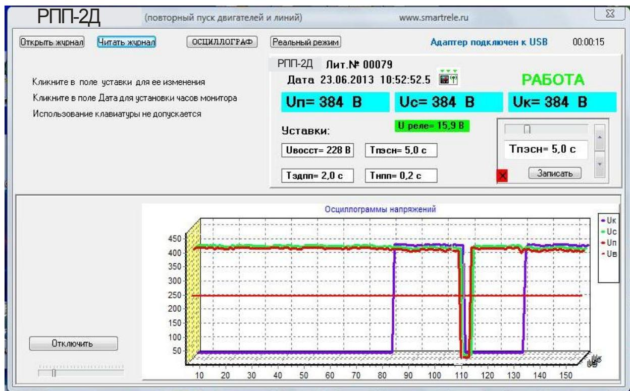
Рисунок 4 - отображение мониторинга работы двигателя, оснащенного реле РПП-2Д, в реальном времени
