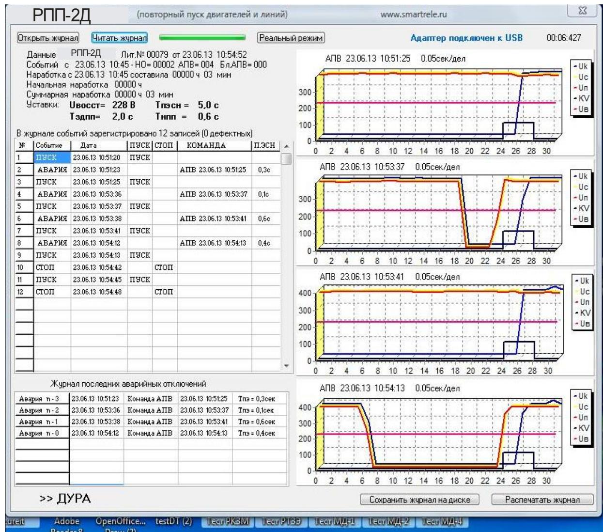
Рисунок 5 - отображение журнала событий реле РПП-2Д на экране ПК
