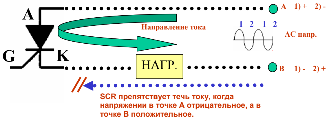
Рисунок 12. Схема полупериодного управления SCR.
