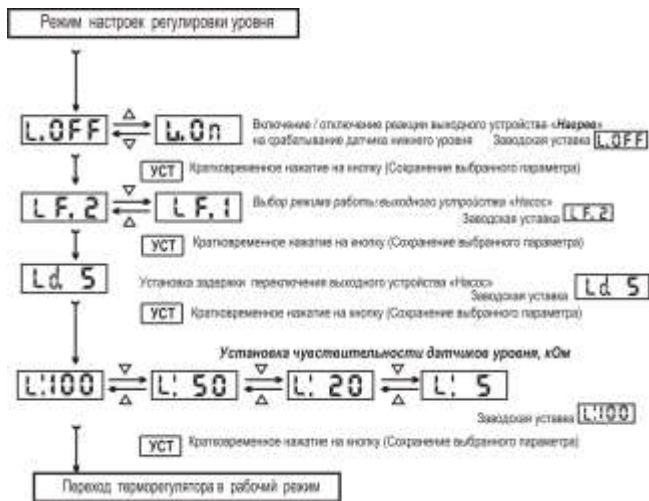
Рисунок 5 – Алгоритм программирования терморегулятора RATAF-02U (продолжение)
