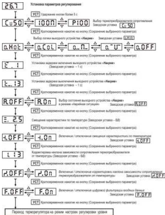
Рисунок 5 – Алгоритм программирования терморегулятора РАТАР-02У (см. продолжение на следующей странице)
