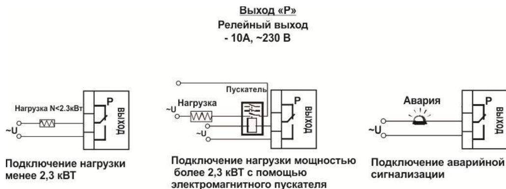
Рисунок 11 – Схемы подключения релейных выходов.
