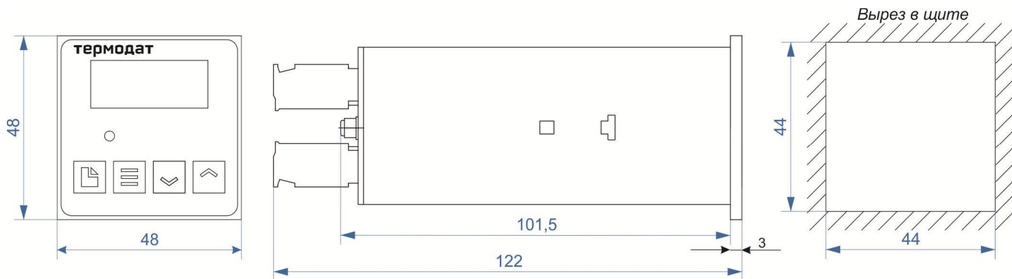
Рисунок 17 – Габаритные размеры прибора 10M7-K
