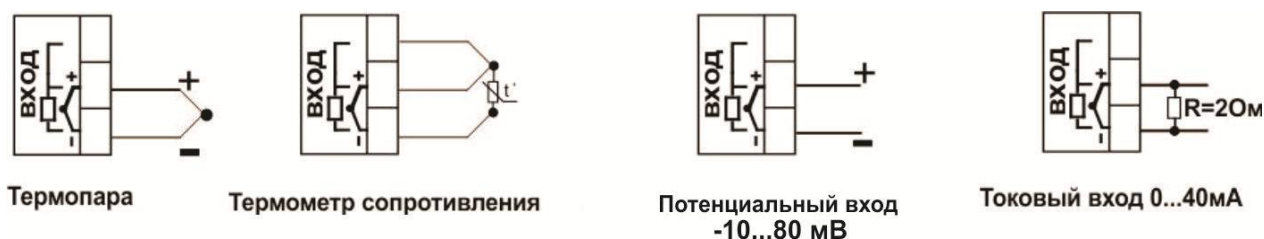
Рисунок 10 – Схема подключения датчиков температуры
