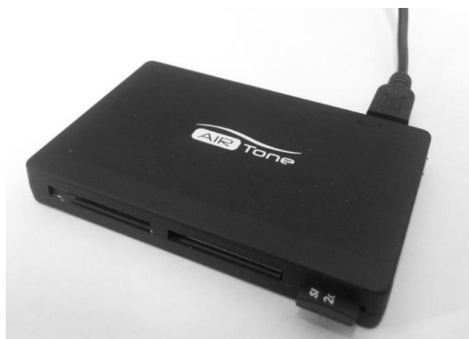
Рисунки 19 – специализированное устройство чтения карты памяти (Card Reader)
