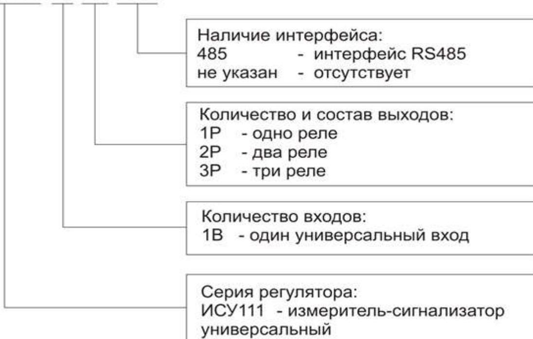
Пример для записи: ТРИД ИСУ111-1В1Р-485 (Измеритель-сигнализатор универсальный с одним входом, с одним релейным выходом, с интерфейсом RS485).
