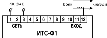
Рисунок 5.3 – Схема подключения с трансформатором
